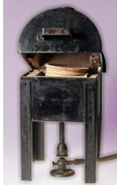
Velká těžká a klenutá pec s přírubou na odvodušňování. Stojí na čtyřech vysokých nožkách a zdrojem tepla je Bunsenův kahan. Licí váleček stojí na skládacím roštu. Komůrka měří 11 x 11 x 13 cm (neznámý výrobce, kolem r. 1910).
