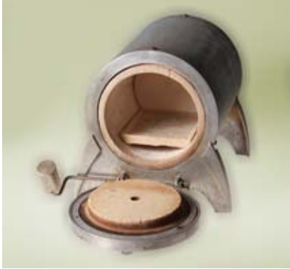
Okrouhlá železná pírka spočívající na podstavci z ohýbaného hliníku. Uvnitř je šamotový válec se zapuštěnou topnou spirálou (220 V a 750 W). Vypalovací pírka stojí na další šamotové desce, pírka měří 19 x 21 x 12 cm (firma Rost, kolem r. 1950).
