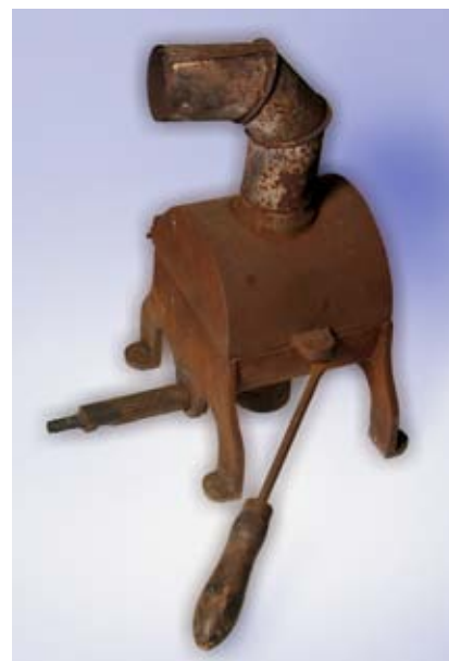
Těžká předehřívací pec z litého železa. Do spodní části lze umístit ležatý Bunsenův kahan. Horní část obsahuje zařízení na odvodušňování. Vnitřek je vystlan šamotem, licí váleček je umístěn na roštu z litého železa. Komůrka měří 11 x 11 x 10 cm (neznámý výrobce, kolem r. 1920).
