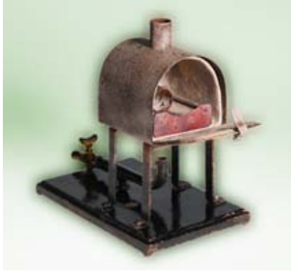
Malá předehřívací pírka dle dr. Grahwinkela je připevněna na základní desce o rozměru 13 x 20 cm. Tepelným zdrojem je ležatý Bunsenův kahan. Komůrka měří 8 x 7 x 8 cm, je na jeden licí váleček. Spodek tvoří rošt vystlaný azbestem, celková výška činí 21 cm (neznámý výrobce, kolem r. 1890).
